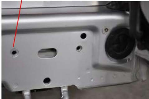
Adapter dient hierbei als Bohrschablone.
