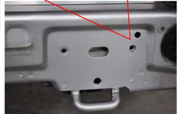
Adapter dient hierbei als Bohrschablone.
