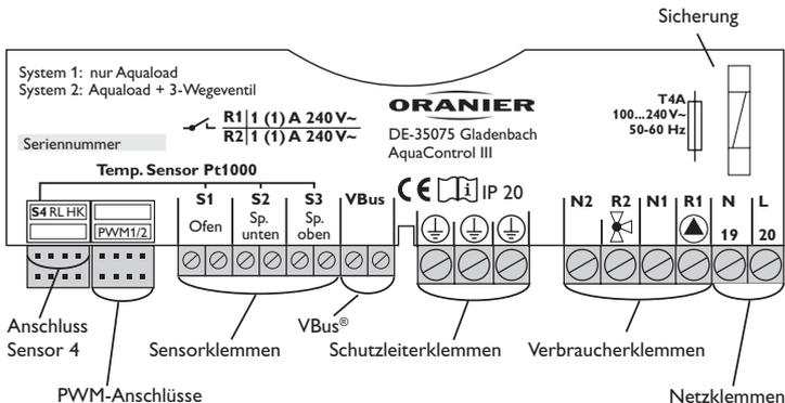
Die **Temperatursensoren** (S1 bis S4) mit beliebiger Polung an den folgenden Klemmen anschließen:
