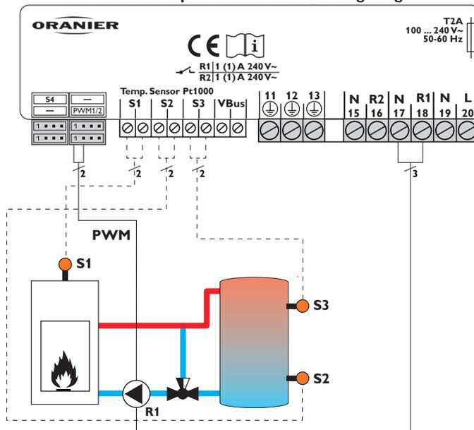
Bei der Ansteuerungsart **PWM** erfolgt keine Drehzahlregelung über das Relais. Es muss ein gesonderter Anschluss für das PWM-Drehzahlsignal gemacht werden (siehe Abbildung).
