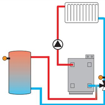
Die Funktion **Rücklaufanhebung** dient dazu, Wärme aus einer Wärmequelle an den Heizkreisrücklauf zu übertragen.
