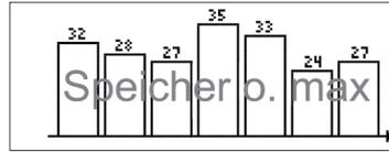
In diesem Bilanzdiagramm wird die am oberen Speichersensor gemessene Maximaltemperatur der letzten 7 Tage dargestellt.
