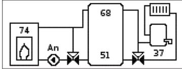
In der Systemanzeige wird das ausgewählte Systemschema grafisch angezeigt. Verschiedene Messwerte, Pumpendrehzahlen sowie Ventilstände können ebenfalls abgelesen werden.
